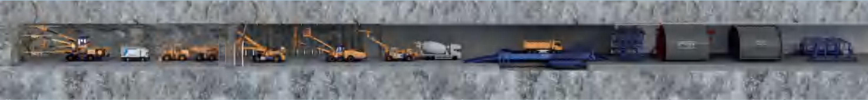
三臂凿岩台车 | 装药台车 | 出碴作业线 | 拱锚台车 | 锚注一体台车 | 湿喷台车 | 仰拱栈桥 | 防水板钢筋铺设台车 | 模板台车 | 养护台车 | 水沟电缆槽台车
