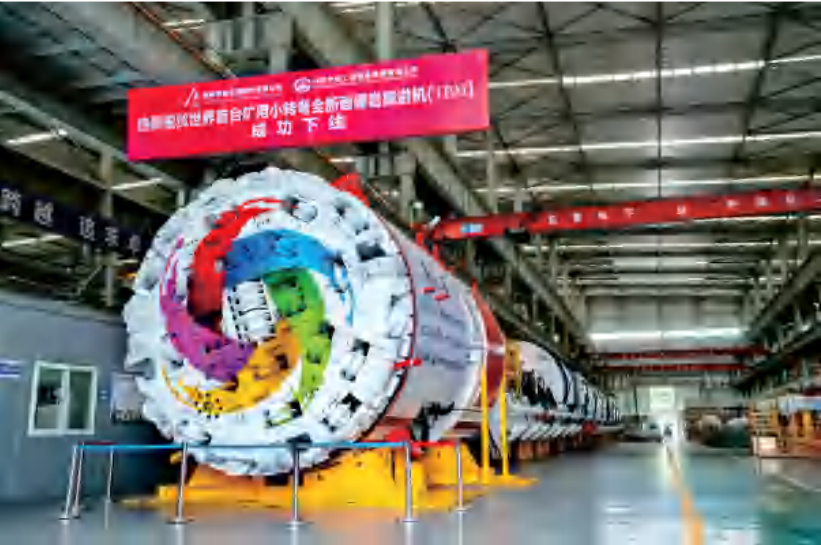
世界首台矿用小转弯全断面硬岩掘进机
