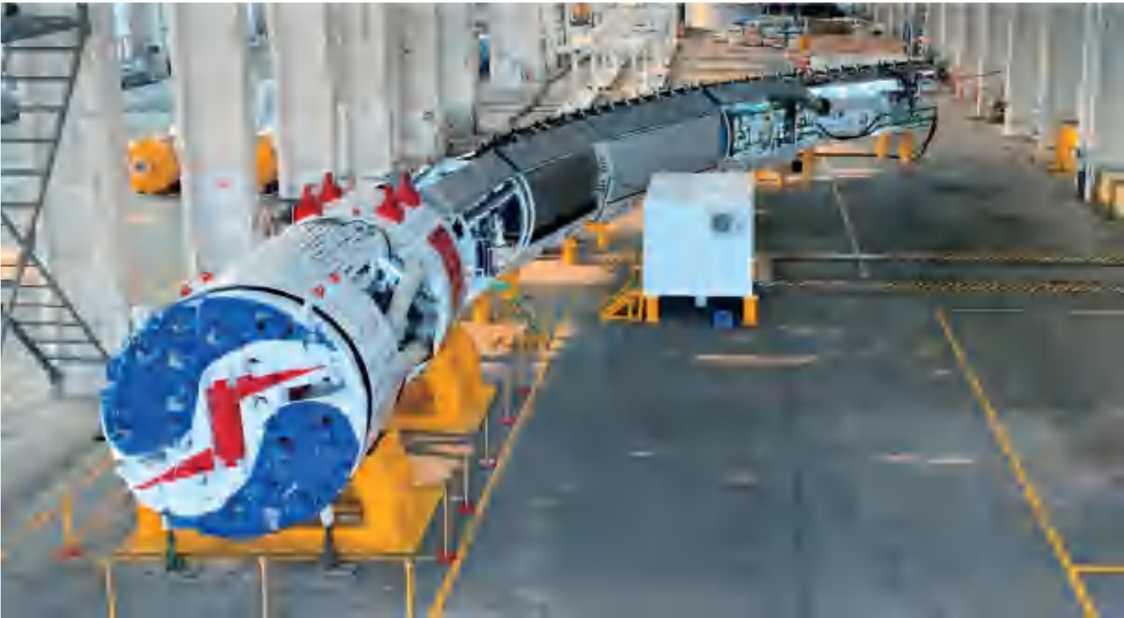
世界首台紧凑型超小转弯半径硬岩掘进机
