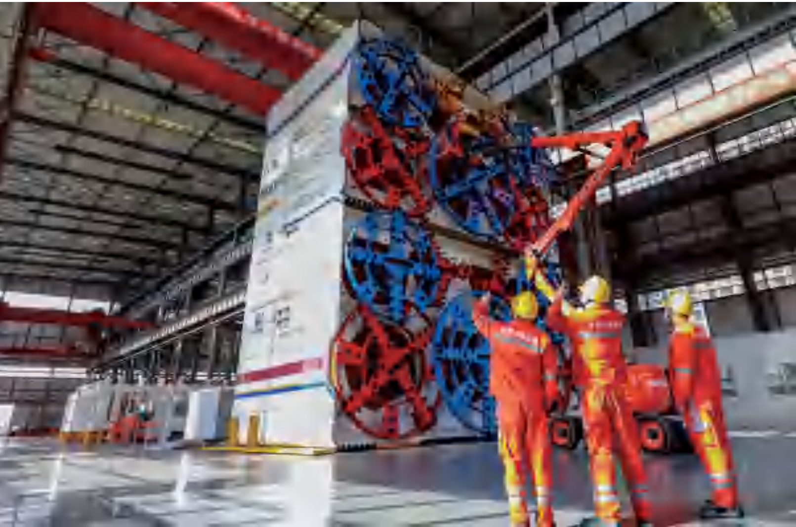
“中铁1179号”世界最大断面组合式矩形盾构顶管机·深圳地铁12号线沙三站
