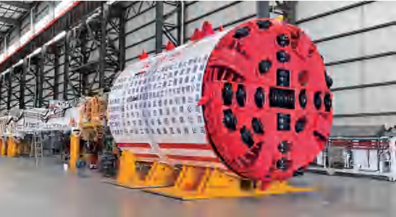
世界引调水工程最小直径单护盾硬岩掘进机
