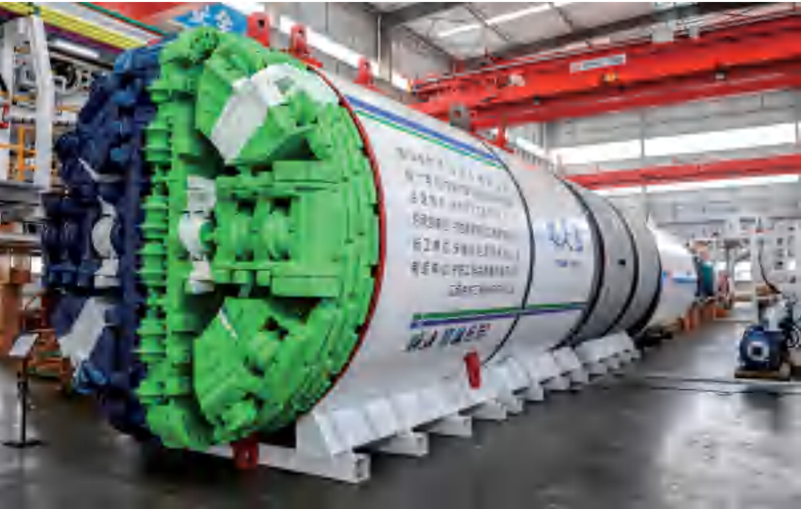
“中铁1268号”·长沙雷锋水厂桃花岭穿山隧道段硬岩泥水平衡顶盾机
